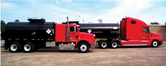
▲ Le Fill-Coat® no 1, matériau de remplissage de gaine injecté à chaud, est transporté et réchauffé dans de grands camions citernes.
